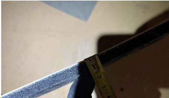
Kuva 1. ASB.01, Liikuntasalin lattian pintamateriaali + liima + tasoitelaasti
